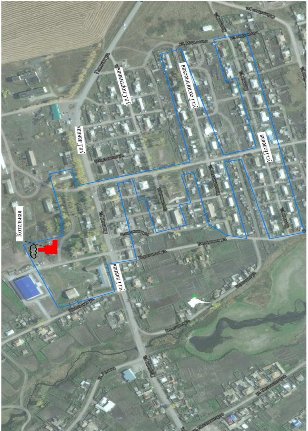
Приложение 2. Схема расположения существующего источника тепловой энергии и зоны его действия (без изменений)
